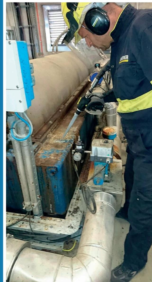
Trockeneis reinigt ohne Wasser und ohne Chemie, ist elektrisch nicht leitend, ungiftig und nicht brennbar. Es geht direkt in den gasförmigen Zustand über und vergrößert dabei sein Volumen um etwa das 700- bis 1000-fache. Dabei sprengt es den Schmutz von der Oberfläche ab ohne diese zu beschädigen.
